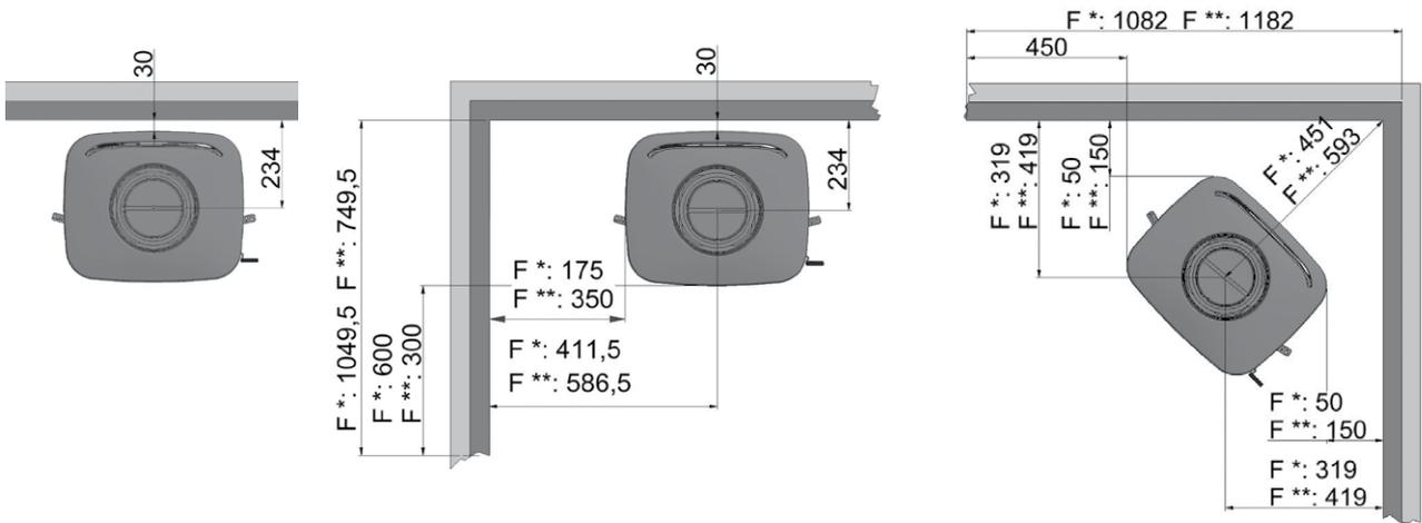
Min. Abstand zu brennbarer Wand mit isoliertem Rauchrohr + Dekorring
