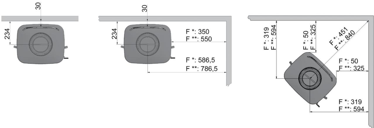
Min. Abstand zu brennbarer Wand mit unisoliertem Rauchrohr
