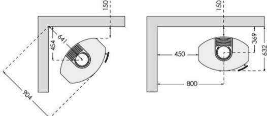
Les distances de sécurité minimales aux objets inflammables sont indiquées sur la plaque d'identité du poêle, elles ne doivent pas être inférieures aux valeurs préconisées.
