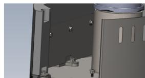
**7.** Placer stenen op mod metalpladen således at gevindhuller passer i de forberedte huller og spænd deretter stenen fast med en 10mm topnøgle. Monter herefter det øverste beslag. Se den hvide pil.
