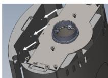
**6. Top frontsten:** Stenen er forberedt med 3 X gevind huller hvor de medfølgende bolte og spændeskiver skal anvendes.
