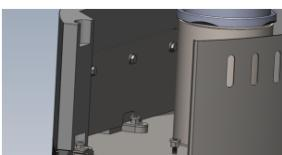
**7.** Placez la pierre contre le support métallique afin que ses trous se trouvent en face des trous du support. Fixez ensuite la pierre avec les boulons fournis à l'aide de la clé à douilles. Puis montez la fixation supérieure (la flèche blanche).
