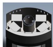
**6. Top Frontstein:** Die Steine sind mit 3 x Gewindelöchern vorbereitet, wo die mitgelieferten Bolzen und Unterlegscheiben reinpassen.
