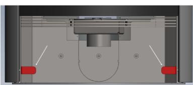
**5. La pierre frontale INFÉRIEURE:** Fixez les équerres (fournies) à l'intérieur du compartiment en bas du poêle. Ajustez-les d'une manière que les pierres restent en place et sont affleurées aux bords du poêle.
