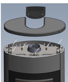
**10. La pierre supérieure:** Ajustez les boulons des piques à niveau, puis posez le plateau supérieur avec les piques en face des trous de la pierre.
