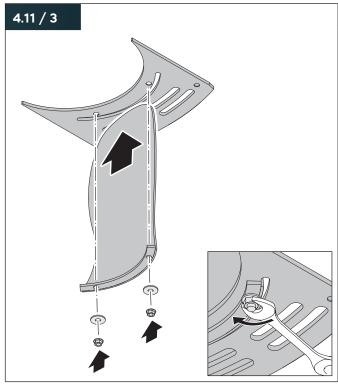
▶ Wenn erforderlich, schrauben Sie die Strahlschutzhutze für den Rauchgasabgang nach oben an die Abdeckplatte.
