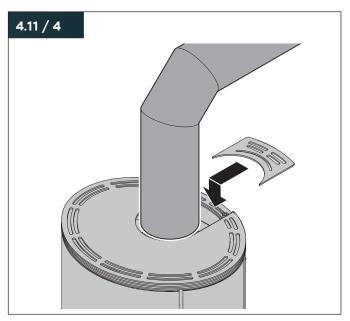
Setzen Sie die Abdeckplatte oben auf das Gerät.
