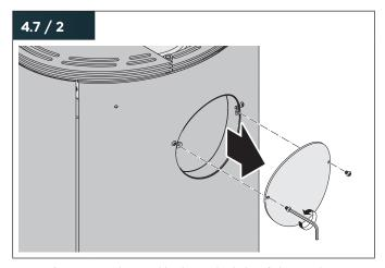
Entfernen Sie den Verkleidungsdeckel auf der Rückseite.
