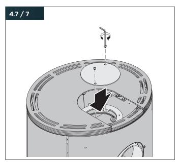
Schrauben Sie den Blinddeckel von der Rückseite oben auf den Abgasanschluss. Achten Sie dabei auf den korrekten Sitz der Dichtungen.
