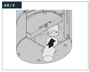
Verbinden Sie die Verbrennungsluftleitung mit dem Verbrennungsluftstutzen.
