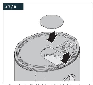
Setzen Sie den Blinddeckel und die Abdeckplatte oben auf das Gerät.
