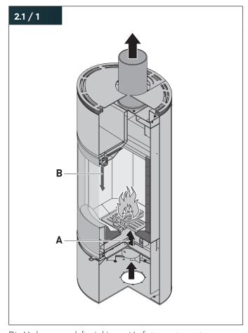
Die Verbrennungsluft wird in zwei Luftstromarten unterschieden:
