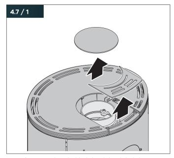
Entfernen Sie den Blinddeckel und die Abdeckplatte.
