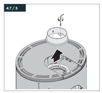
Schrauben Sie den Abgasstutzen oben vom Gerät ab.
