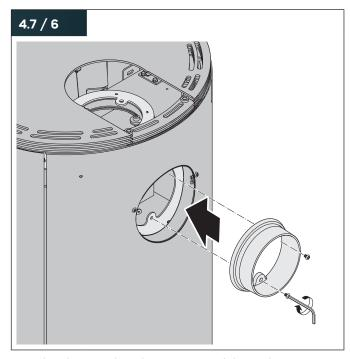
Schrauben Sie den Abgasstutzen auf die Rückseite vom Gerät. Achten Sie dabei auf den korrekten Sitz der Dichtungen.
