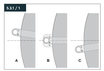
Die Regelung der Verbrennungsluft erfolgt stufenlos durch Betätigen des Verbrennungsluftschiebers bei geschlossener Feuerraumtür.
