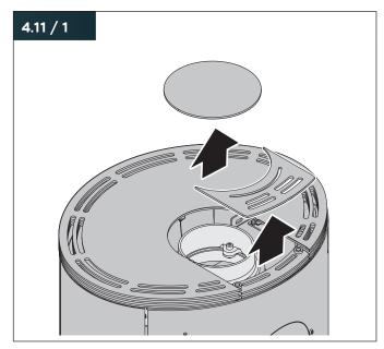
Entfernen Sie den Blinddeckel und die Abdeckplatte.
