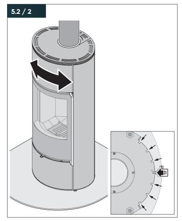
Das Gerät kann auf 7 durch Einkerbungen im Drehteller vorgegebene Winkel justiert werden.
