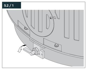
Legen Sie den Feststellhebel am Drehteller nach unten.
