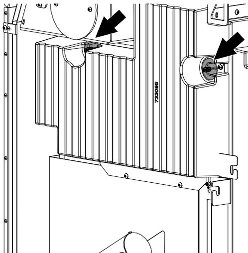
Abb. 14: Hinteren HMS-Stein montieren
