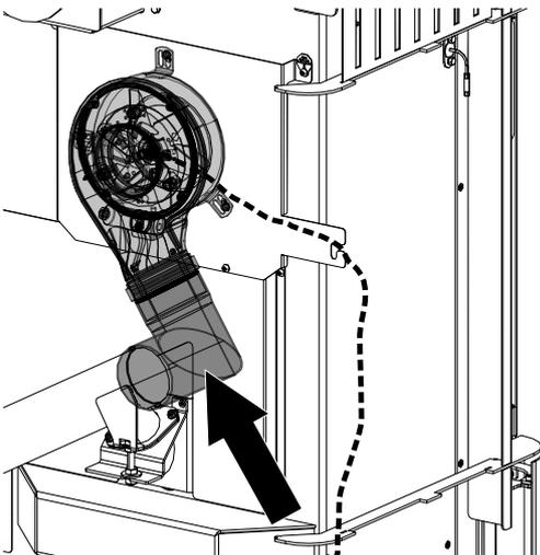
Abb. 29: Rohr raufstecken
