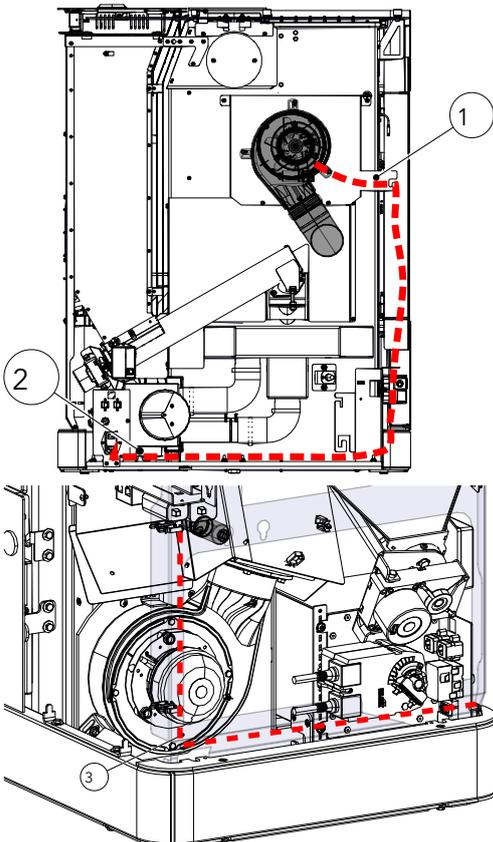
Abb. 25: Kabel verlegen
