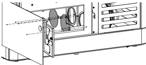
Abb. 99: Abdeckungen abmontieren
