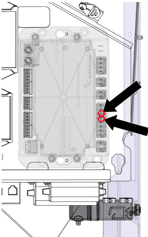
Abb. 27: Luftverteilermodul anstecken
