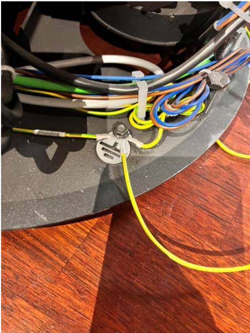
Abb. 28: Zentralerdung anschließen
