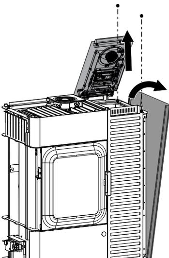
Abb. 106: Rechte Seitenverkleidung abmontieren
