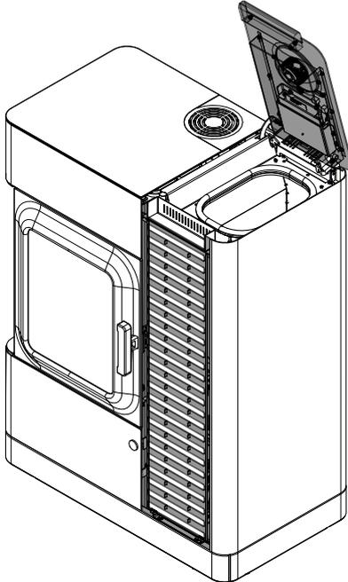
Abb. 41: Pellets füllen
