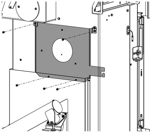
Abb. 12: Blech entfernen
