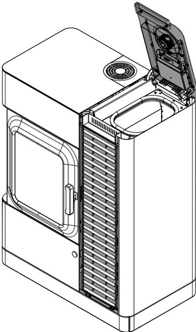
Abb. 74: Fronträger demontieren
