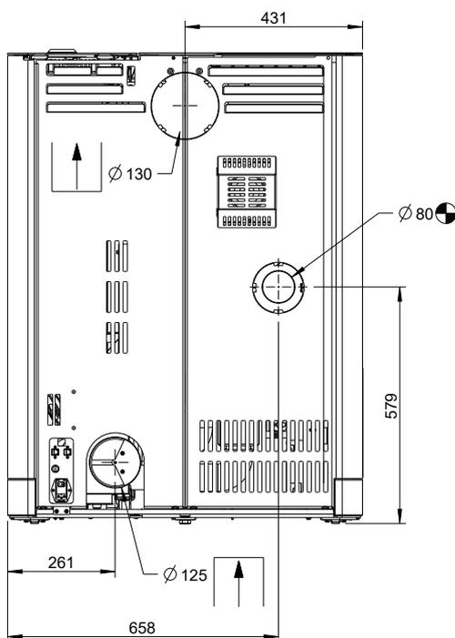
Abb. 33: Anschluss Verbrennungsluftzufuhr
