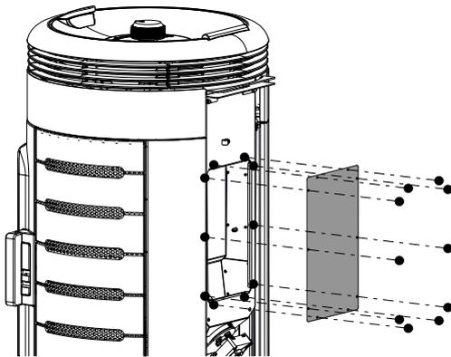
Abb. 16: Abdeckung abmontieren
