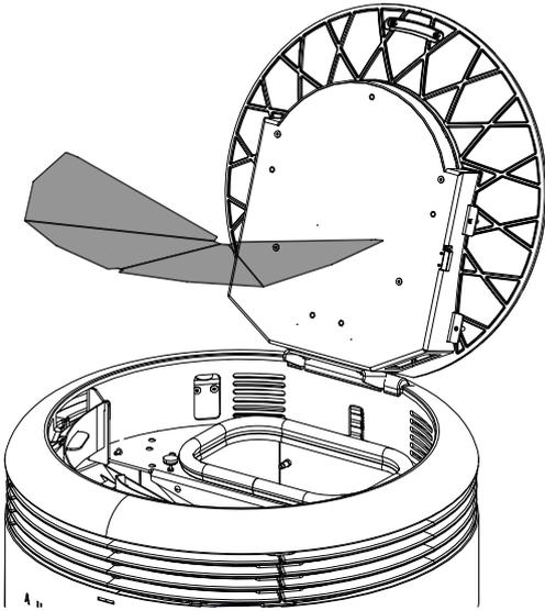
Abb. 44: Strahlungsschutzblech herausnehmen
