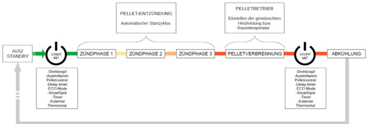
Abb. 31: Funktionsdiagramm
