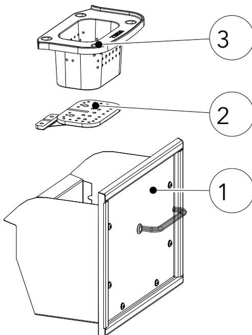
Abb. 41: Kipprost reinigen
