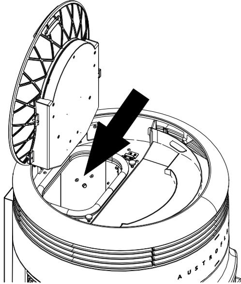
Abb. 23: Pellets füllen
