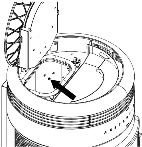
Abb. 39: Schraube lösen
