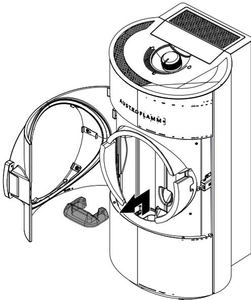
Abb. 26: Keramik-Stein entfernen
