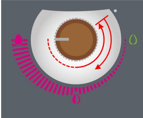
Die Einstellung der Raumtemperatur ist im Bereich von +5 °C (Frostschutz) bis +40 °C möglich. Nach dem Einstellen der gewünschten Raumtemperatur wird Ihre Auswahl nach ca. 5 Sekunden mit einem kurzen Blinken bestätigt.
