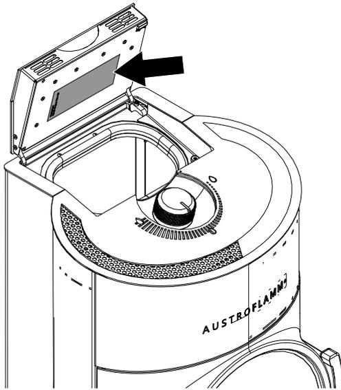
Abb. 3: Typenschild Clou Compact Pellet
