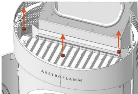
Abb. 33: Befestigungsschrauben abschrauben
