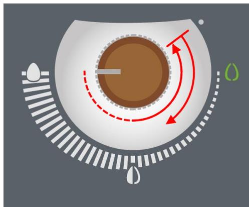
Die Heizleistung kann in 5 Stufen eingestellt werden.
