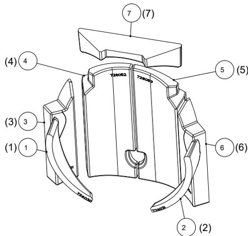
Nummerierung in der runden Klammer = Einbaureihenfolge
