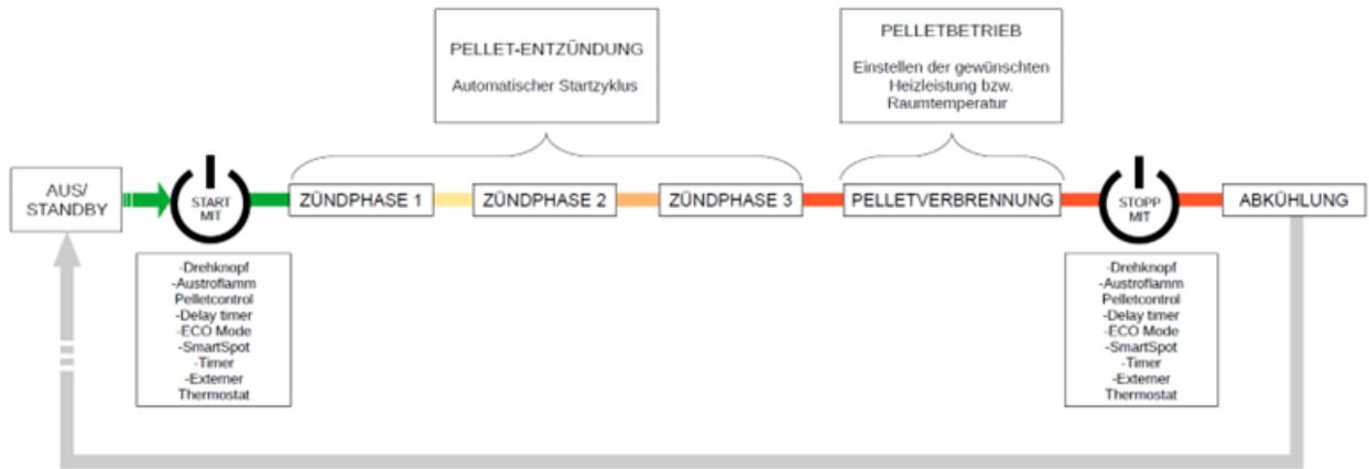
Abb. 16: Funktionsdiagramm
