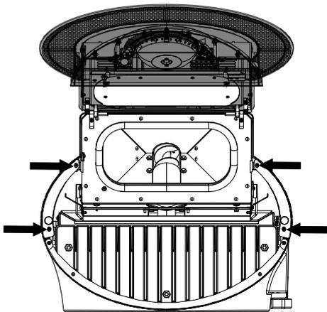
Abb. 42: Schrauben lösen
