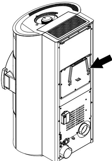
Abb. 25: Hebewerkzeug
